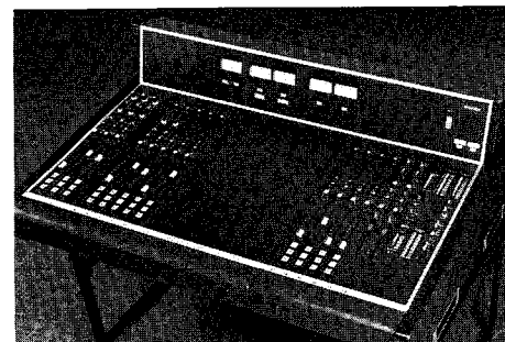
Mit dem neuen Regiepult Studer 970 verfügen wir nun über ein leistungsfähiges Sendepult, das auch für die Selbstfahrtechnik (Disk Jockey-Betrieb) bestens geeignet ist.
